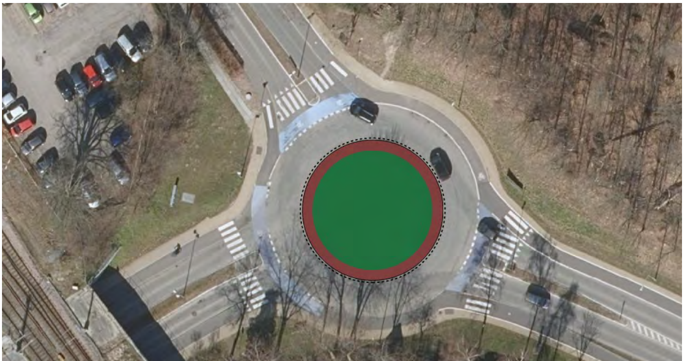
Midterøen forhøjes, og eksisterende beplantning fornyes. Det overkørbare areal etableres med 4-5 cm lysning og forhøjes mod midten. Suppleres med afmærkning rundt om det overkørbare areal.
