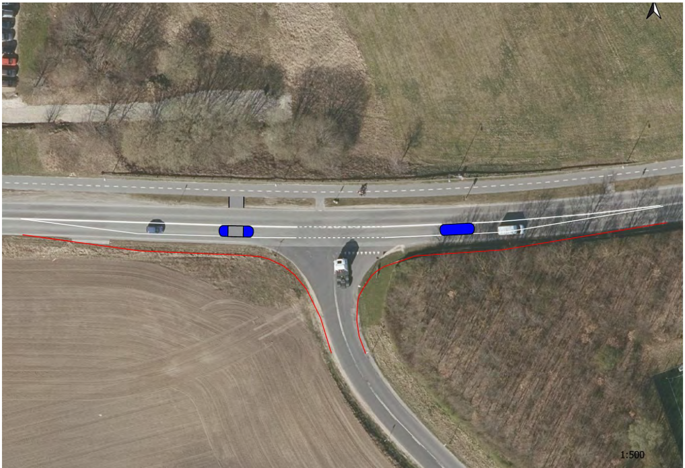
Princip for midterheller på Sortemosevej, som kan benyttes af krydsende bløde trafikanter, og som samtidig giver et midterfelt til venstresvingende.
